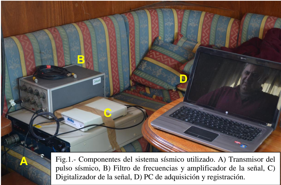
Figura 8. Instrumental Geofísico instalado (Transmitter GeoPulse y Digitalizador)
