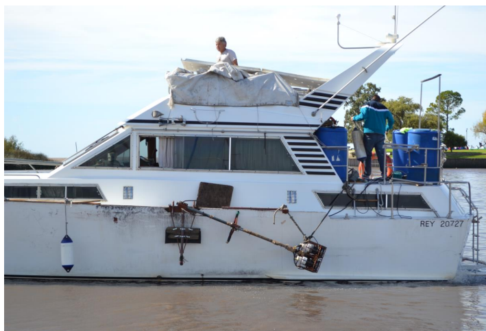
Figura 5. Embarcación CARIBDIS y perfilador de subsuelo
