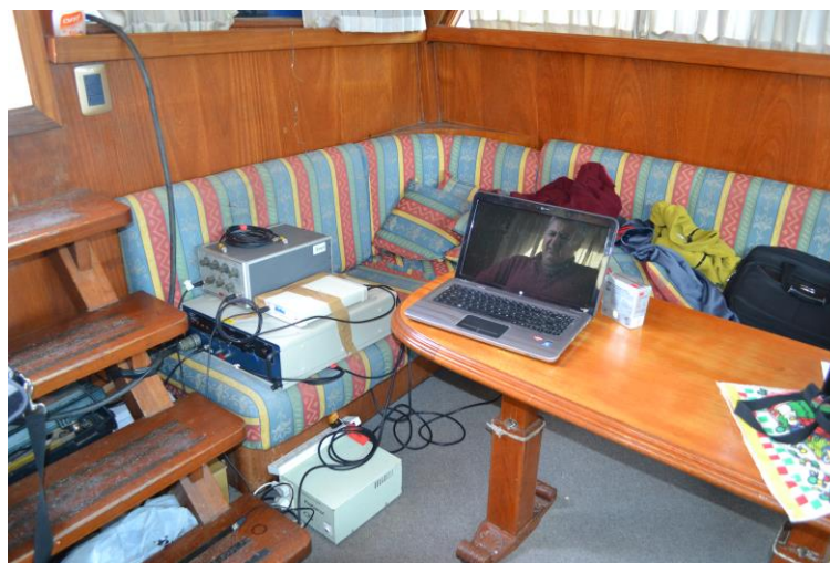
Figura 7. Componentes electrónicos de procesamiento. Perfilador de subsuelo.
